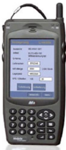
МЗ основан на концепции модульного подключения с возможностью расширения. Это позволяет настраивать его под конкретную задачу в зависимости от типа используемого устройства. Благодаря тонкому профилю и степени защиты IP 64 этот КПК является крайне надежным устройством и инструментом, который по необходимости можно положить в карман. Опции GPS и GPRS обеспечивают максимальную функциональную мобильность и полную доступность в любой момент.
