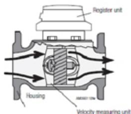
Счетчики воды RUBIN MeiStream работают по принципу учета числа оборотов турбины (счетчики Вольтамана), вращающейся под действием протекающей воды и сконструированы для измерения больших объемов воды. Модульная конструкция механизмов и корпуса позволяет применять счетчик в различных областях управления водоснабжением.
