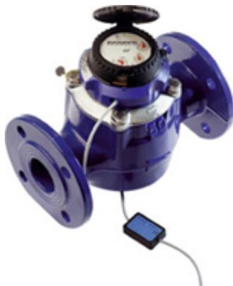
Серия турбинных расходомеров Woltman (Вольтмана) со счётным механизмом сухого хода RUBIN WSDK, принцип работы основан на измерении скорости потока жидкости при помощи вертикальной турбины и передачи на счётное устройство через магнитную муфту.
