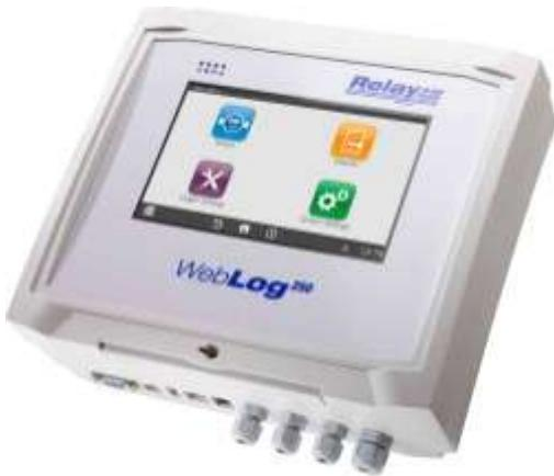
Многофункциональный цифровой M-Bus регистратор данных на 250 устройств с сенсорным дисплеем и Веб-сервером. Порты - USB, Ethernet, 2x RS-232 (C), RS-485. Встроенный блок питания 110 ... 250 В переменного тока. Скорость передачи от 300 до 38 400 бод. Рабочая температура от 0 °C до + 45 °C. Длина сигнального кабеля до 10 км. Экспорт данных в форматах XML, XLS, CSV по электронной почте, FTP или USB . Встроенная память 1 ГБ. Тип защиты IP52.
